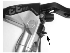
Öffner OHNE Magnet Opener WITHOUT Magnet Contact à ouverture SANS aimant
